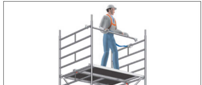
Bild 3: Sichere Montage der Rückenlehnen mit PSA
