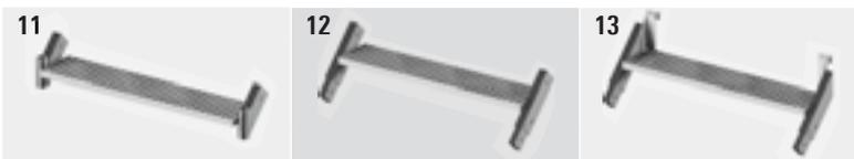
Höhenunterschiede von 0,6 m bis 1,6 m können überbrückt werden. Belastung: 3,0 kN/m<sup>2</sup>. Ausführung: Stahl feuerverzinkt. Verbindung der Treppenelemente mit Bolzen Ø 12 x 55 mm, Art.-Nr. 4905.055 und Sicherungsstecker 2,8 mm, Art.-Nr. 4905.000 (2 Stück je Stoß). (Diese sind im Lieferumfang des Kopf- und des Mittelelements bereits enthalten).
