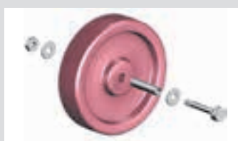
6491.513 Rad inklusive Achse für 1260.200 Gew. 1,1 kg, Ø 150 mm.
