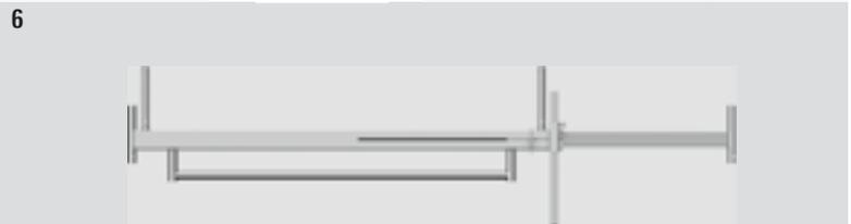
Die Teleskopiereinrichtung: Breite max. 3,2 m, min. 2,3 m. Der Fahrbalken kann bei sämtlichen Gerüstsystemen, (Fahr-, Rahmen-, Modul- und Fremdgerüste sowie Rohr und Kupplung) mit einem Rohrdurchmesser von 48,3 mm verwendet werden.
