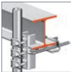
Die Einhängung der **Hängegerüstkupplung 1** erfolgt in vorhandene Winkel-, U- oder I-Profile. Sie haben durch die drei angeieteten Halbkupplungen (für Gerüstrohre 48,3 mm) eine zulässige Belastung von 15 kN. Die
