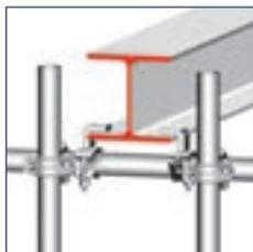
Die **Klammerkupplungen 3** für Gerüstrohre 48,3 mm sind besonders vorteilhaft bei großen Flanschbreiten. Der Anschluss an den Flansch erfolgt immer mit zwei Klammerkupplungen. Zulässige Belastung 9 kN je Klammerkupplung in
