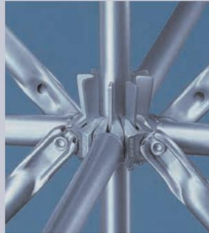
**Das Ergebnis überlegener Konstruktion.** Bis zu 8 Anschlüsse lassen sich im statisch idealen Allround Knoten auf einer Ebene in verschiedenen Winkeln anschlagen. Anschlagmöglichkeiten sind im Rastermaß von 50 cm an allen Allround Stielen vorgesehen. Die flache Lochscheibe verhindert ein Zusetzen mit Schmutz aller Art.
