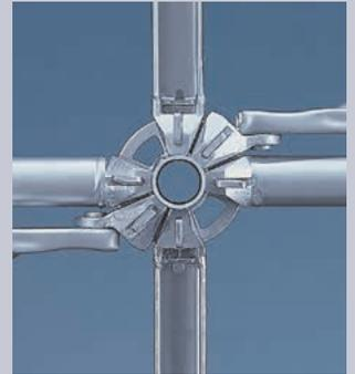
**Geniale Verbindungstechnik.** Die 4 kleinen Ausstanzungen der Lochscheibe zentrieren den Riegel automatisch im rechten Winkel, die 4 großen erlauben ein Ausrichten mit freier Winkelwahl.
