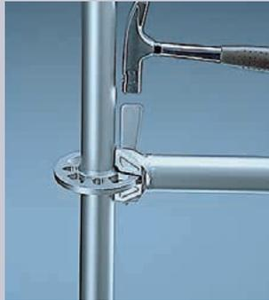
Ein Hammerschlag auf den Keil wandelt den Formschluss in den Kraftschluss. Die Stirnseite des Keilkopfes liegt jetzt exakt am Stiel an.
