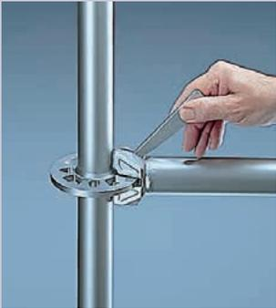
**Das AllroundGerüst weist eine einfache, einzigartige und schraubenlose Verbindungstechnik auf.** Keilkopf über die Lochscheibe schieben und Keil einsetzen, schon ist das Bauteil gegen Herausfallen und Verschieben gesichert. Zum Befestigen des anderen Riegelendes ist noch genügend Spiel vorhanden.
