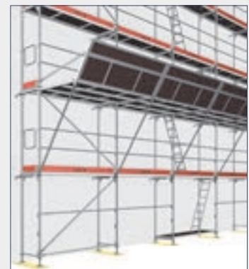
Je Feld müssen zwei Seitenschutzgitter in die Schutzgitterstütze eingehängt werden.
