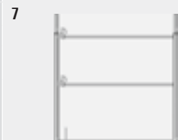
Die EuroBlitz Geländerstütze einfach wird für Konsolen 0,36 m verwendet. Der stirnseitige Geländerabschluss erfolgt mit Rohren und Kupplungen. Ein Stirnbordbrett muss bauseits eingepasst werden.
