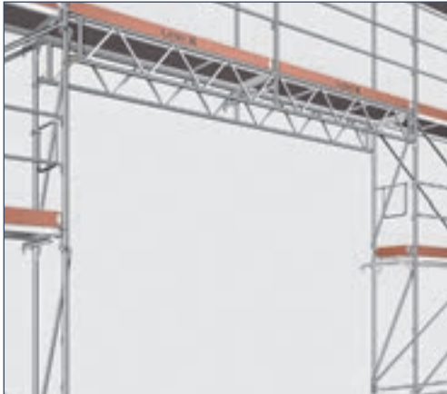
Beispiel: Blitz Gitterträger 5,14 m, bekleidetes Gerüst (gesonderte Diagonalführung)
