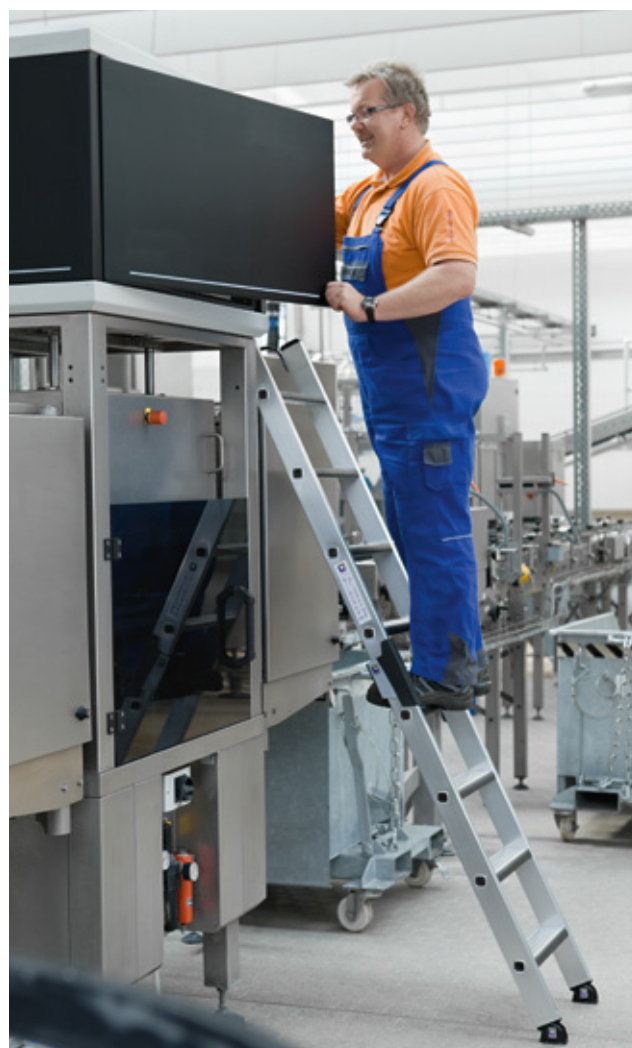
Exemplarische Darstellung, Fixierung der Leiter mit Haken
