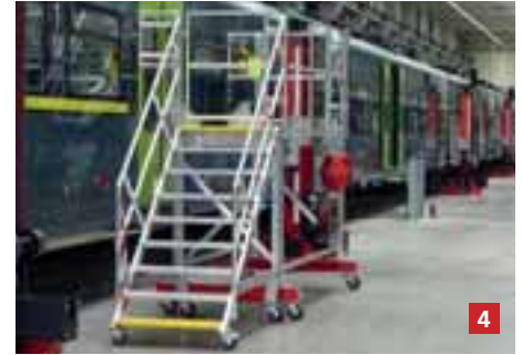
4. Mobile Seitenarbeitsbühne zum Bearbeiten der unteren Seitenbereiche
