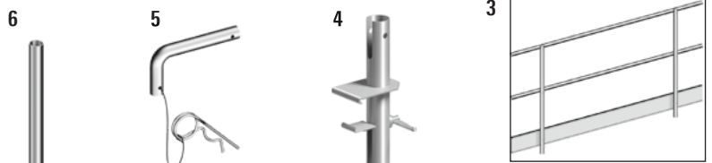
Aufbau mit Geländer-Befestigungsstiel , Gerüstrohren und Normkupplungen.
