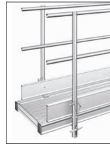
Aufbau mit Geländer-befestigung und Doppel-Geländer mit Bordbrett .
