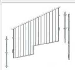
Variante Bestuhlung: Seitengeländer in der Systemachse
