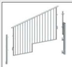
Variante Sitzbank: Seitengeländer neben der Systemachse
