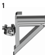
1 Die Konsole, 0,22 m für 0,19 m breite Böden
